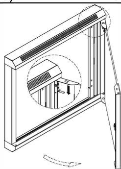
**【2】** Откройте переднюю дверь при помощи ключа, потяните дверную защелку вниз как показано на изображении. Отсоедините переднюю дверь от рамы и отложите ее в сторону.
