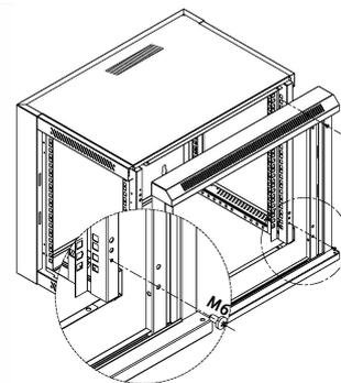
**【6】** Закрепите переднюю раму при помощи 4 винтов М6х12 (используйте 6 винтов, если расстояние больше 18U) как показано на изображении.
