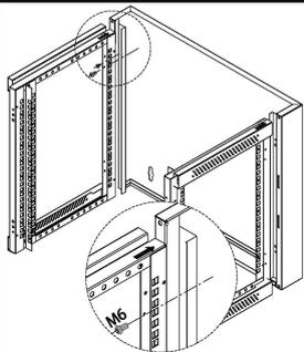
**【4】** Установите боковые рамы в установочный желоб задней рамы при помощи 4 винтов М6х12 (используйте 6 винтов, если расстояние больше 18U) как показано на изображении. Обратите внимание, что полозья находятся спереди.
