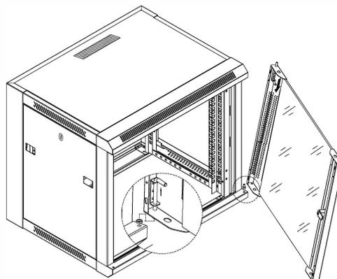
**【8】** Повторите шаг 2 в обратном порядке для установки двери. Совет: шкаф представляет собой конструкцию, которая держится на болтах. Необходимо отрегулировать размер шкафа по диагонали после сборки. Убедитесь, что расстояние между панелями одинаково, а дверь свободно открывается и закрывается.
