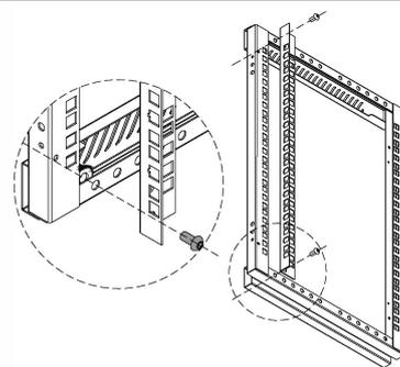
**【3】** Закрепите 19" полозья в первые отверстия сверху и снизу боковых рам при помощи 4 шурупов М5.
