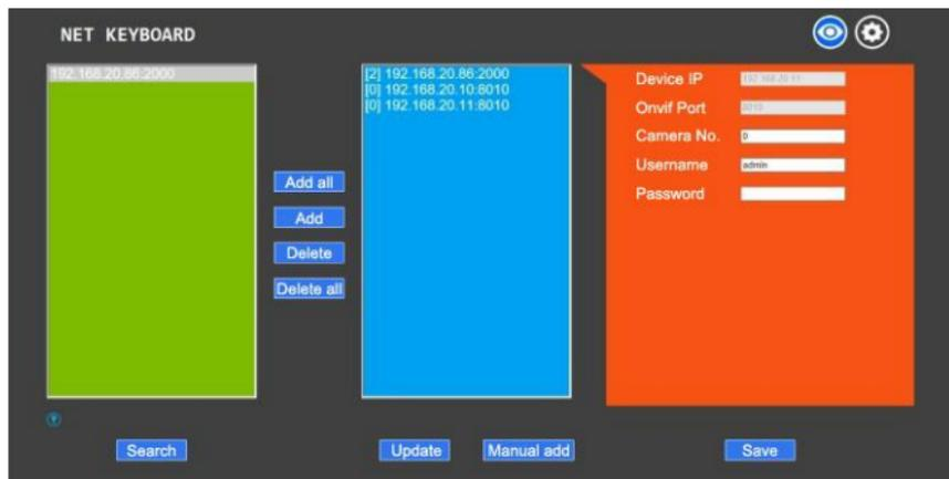
4. Главная страница содержит три списка. Зеленая панель – список поиска устройств; синяя панель – список добавленных устройств; оранжевая панель – информация об устройстве. На желтой панели – добавление вручную.
