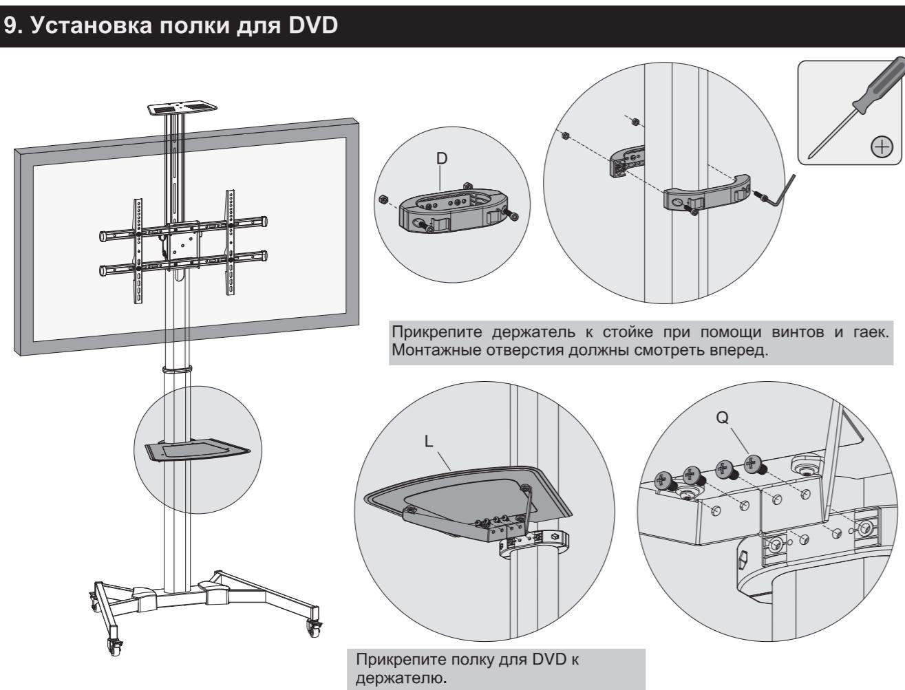
Прикрепите держатель к стойке при помощи винтов и гаек. Монтажные отверстия должны смотреть вперед.
