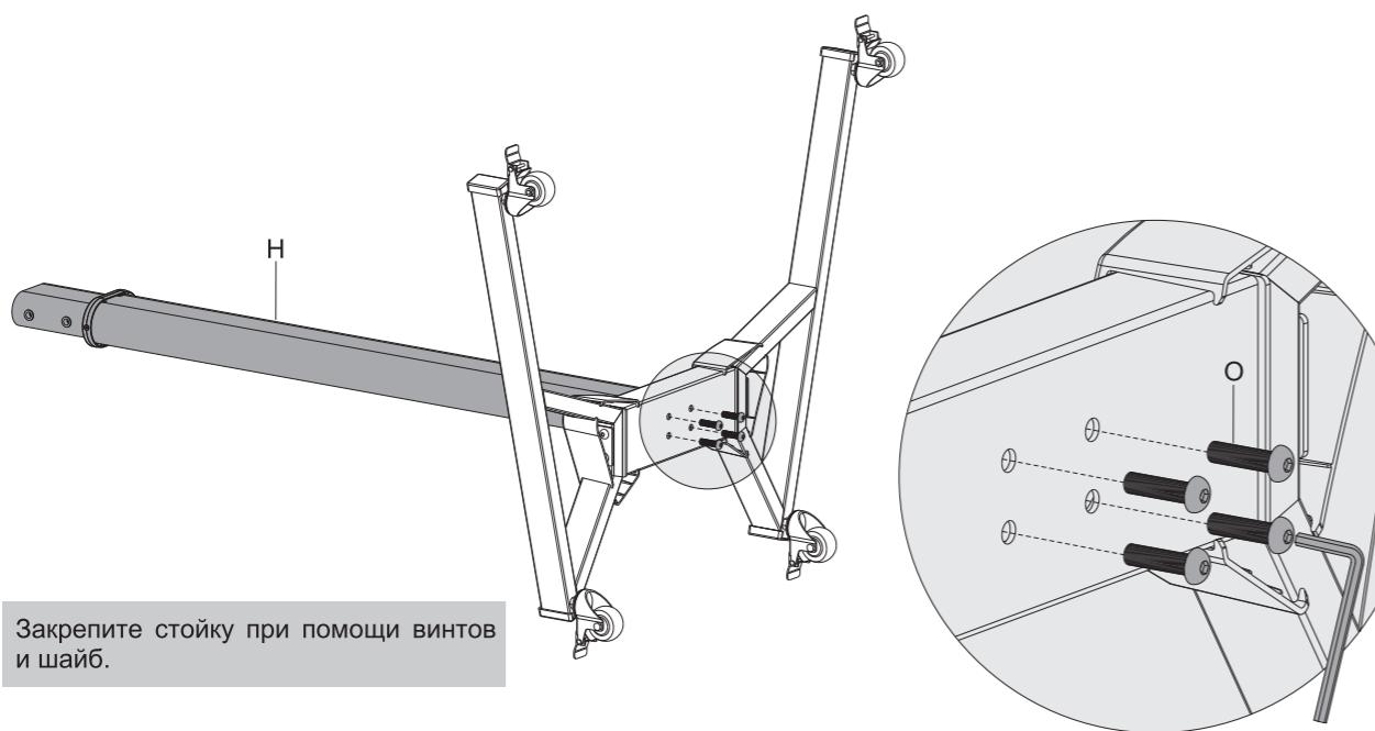
Закрепите стойку при помощи винтов и шайб.
