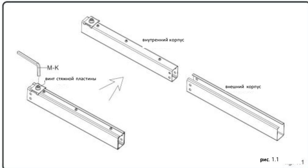
Ослабить три винта соответствующей отверткой и вынуть нижнюю пластину из внутреннего кожуха.
