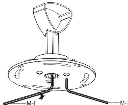
Затяните пластину проектора 6 мм ключом.
