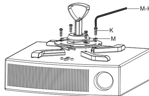
Приверните проектор вместе с пластиной к штанге, используя соответствующие винты и шайбы.
