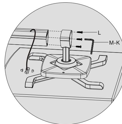
Закрепите пластину с проектором на штангу прилагаемыми винтами.
