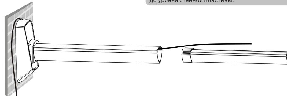
Затем вдвиньте штангу В в направляющую А до желаемой позиции и задвиньте защитную панель на канал В до конца штанги А. Закрепите защитную панель винтами с помощью фиксатора М4.
