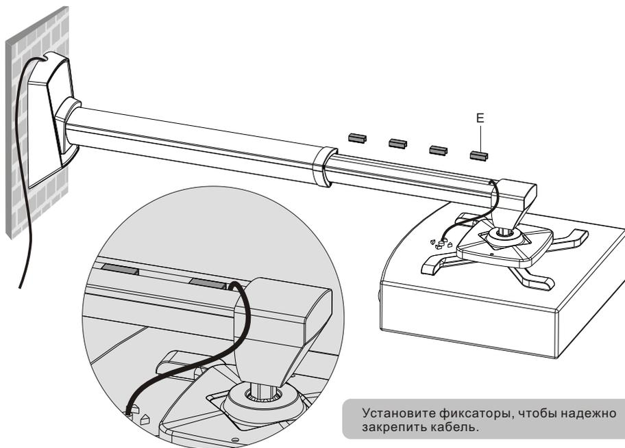
Установите фиксаторы, чтобы надежно закрепить кабель.
