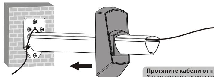
Протяните кабели от проектора через канал А. Затем задвиньте защитную крышку вдоль канала А до уровня стенной пластины.
